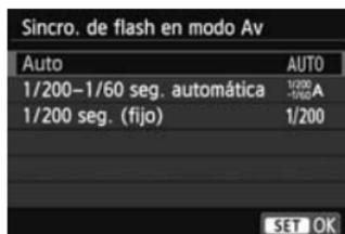
Puede ajustar la velocidad de sincronización del flash para la fotografía con flash en el modo de prioridad a la abertura AE (**Av**).
