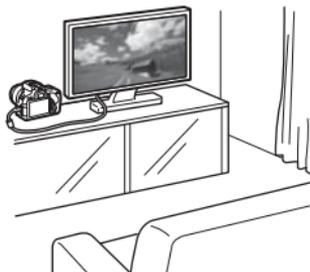
Utilice el cable AV estéreo AVC-DC400ST (se vende por separado) o el cable HDMI HTC-100 (se vende por separado) para conectar la cámara a un aparato de TV. Así podrá reproducir en el televisor los vídeos y las fotos que haya captado.
