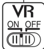
Apague la reducción de la vibración cuando la cámara esté firmemente instalada en un trípode, pero déjela encendida si el cabezal del trípode no está asegurado o cuando utilice un monopie.
